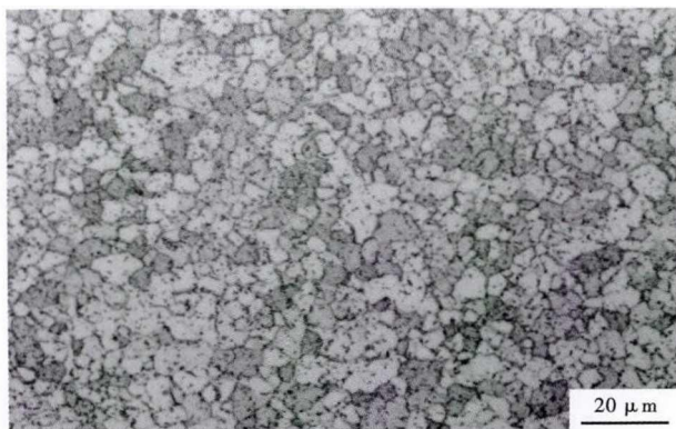
图 5 工艺改进后的 0Cr13C 钢线材的退火组织形貌
